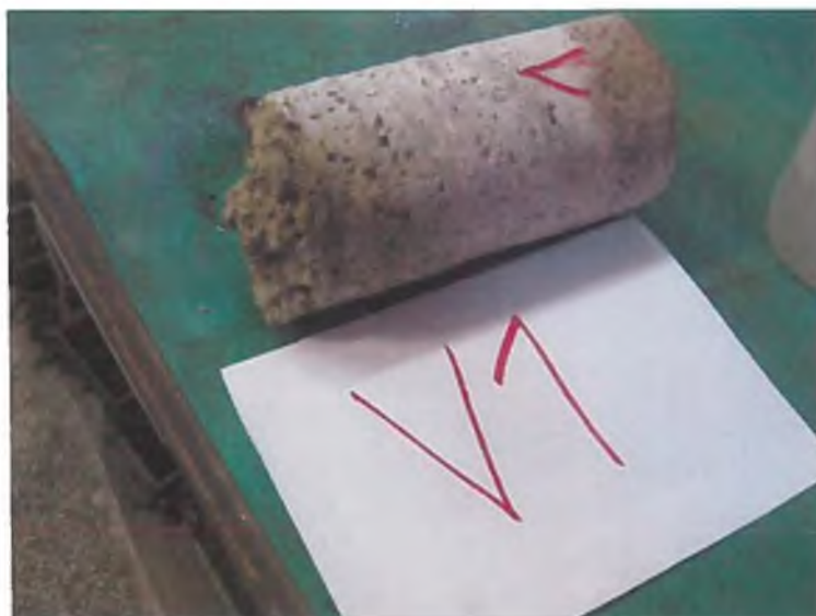
Slika 79: Izvrtani valj V1, viden je tudi rezultat fenolfaleinske preiskave - proces depasivizacije betonov se je očitno že odvil.
