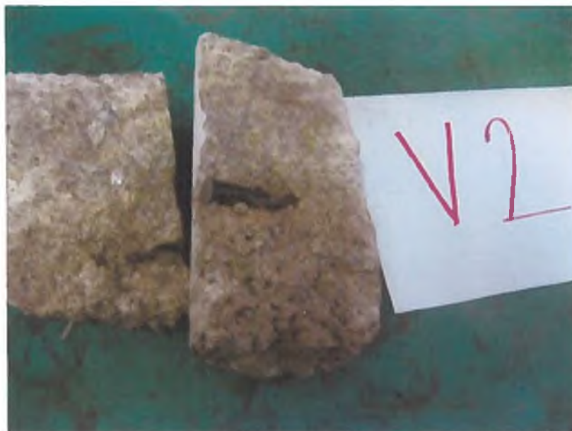
Slika 80: Izvrtani valj V2, razpoka sega preko celotne debeline kupole, fenolftaleinski test - betoni ne nudijo zaščite vgrajeni mehki armaturi.
