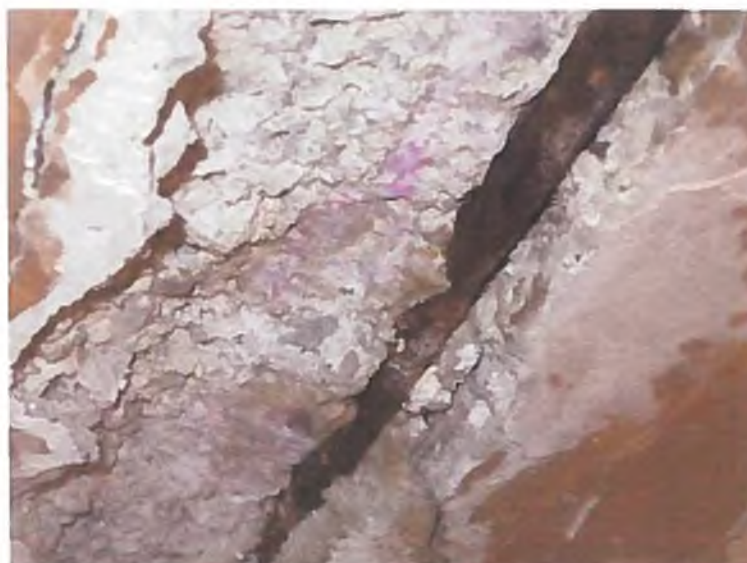
Slika 76: Fenolftaleinski test vgrajenih betonov armiranobetonske kupole – proces depasivizacije betonov se je očitno že odvil, betoni ne nudijo zadostne zaščite vgrajeni mehki armaturi.
