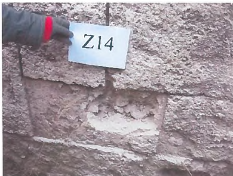
Slika 44: Zidna sonda Z14, gradiva ter sestava kot Z4.
